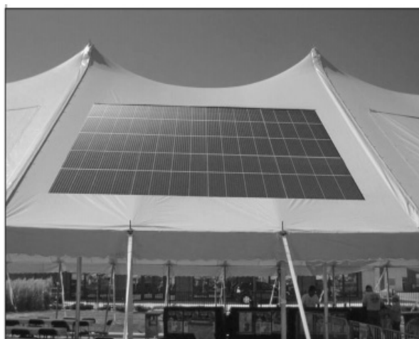
| 有機太陽能電池具有輕薄、可撓曲的優點，幾乎可以安裝在任何地方（資料來源： http://www.konarka.com/ ）。
